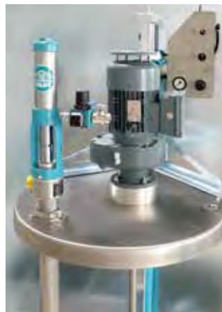
Fasspumpe integriert in pneu- matische Hubanlage für 200-Liter- Fass mit Elektro-Getrieberührwerk Drum pump integrated into pneu- matic lifting system for 200-liter drum, with electrically-powered, geared agitator.
