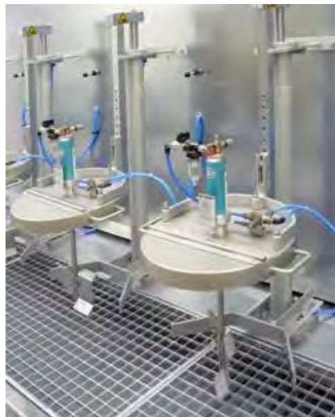
Rührstation mit Hubgeräten, Druckluft-Rührwerken, Auffangwanne, Rückwand, Deckel zu 1/3 aufklappbar Agitator station with lift devices, air-driven agitators, drip pan, rear panel, 1/3 of the lid can be folded back
