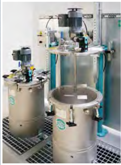
Farbversorgung mit Hubeinrichtung für Druckbehälterdeckel und Elektrorührwerken. The paint is supplied with an electric agitator and a lift for the pressure tank cover.
