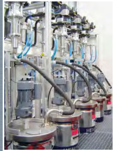
Farbförderanlage mit Deckelhubeinrichtungen für Hobbocks, Elektrorührwerken und Wagner Kolbenpumpen. Paint conveyance system with cover lift system for hobbocks, electric agitators, and Wagner piston pumps.
