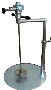
Einstellrührwerk mit Stativ Adjustable agitator with stand
