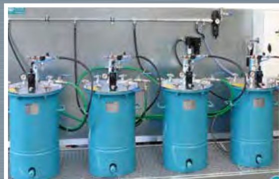
2-Komponenten-Misch- und Dosieranlage WAGNER FlexControl plus XL. Die FlexControl plus XL ist extrem leistungsstark und für den Einsatz mehrerer Pistolen ausgelegt. Steuerteil und Fluidteil sind getrennt. Die Förderung der einzelnen Komponenten und des Härters erfolgt in diesem Fall ausschließlich über Druckbehälter.
