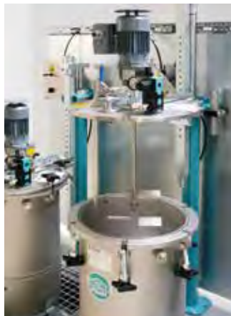
Pneumatische Deckelhubvorrichtung siehe Auswahlbrochure / Pneumatic cover lift See selection brochure: www.walther-pilot.de
