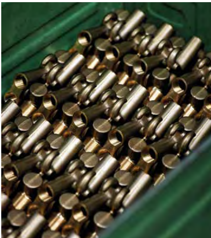
Messingrohkörper für Pistolen Brass raw body for guns.
