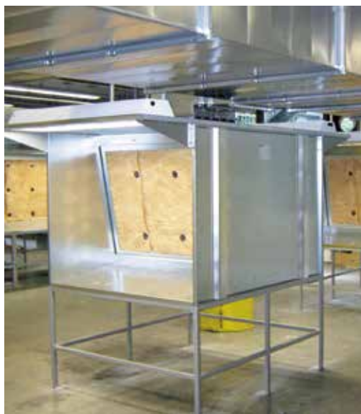
Absaugtisch 2000 in Sonderausführung mit gegenüberliegenden Arbeitsplätzen Extraction table 2000 in special design with opposite workplaces
