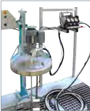
Rührstation mit Auffangwanne, pneumatischem Heber und SprayPak
