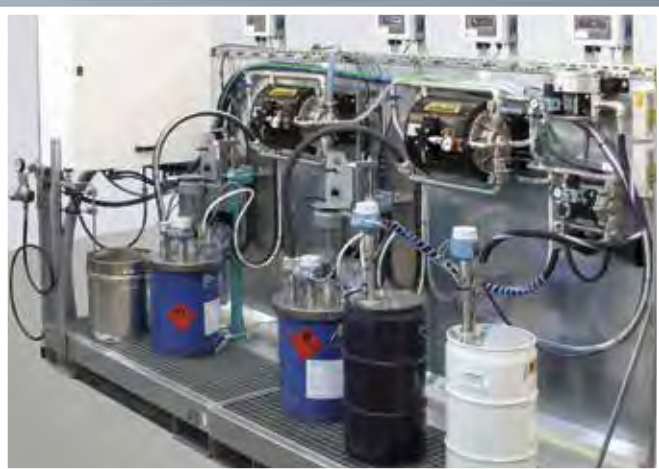
3-Komponenten-Misch- und Dosieranlage mit druckübersetzten Doppelmembranpumpen und elektronisch gesteuertem WAGNER Dosier- und Mischsystem Flex-Control.
